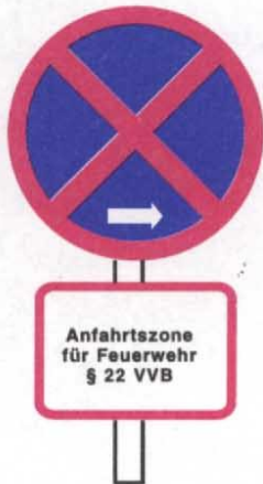
Zeichen 283 am linken Ende der Anfahrtszone
