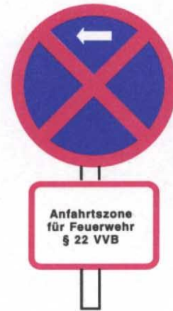
Zeichen 283 am rechten Ende der Anfahrtszone
